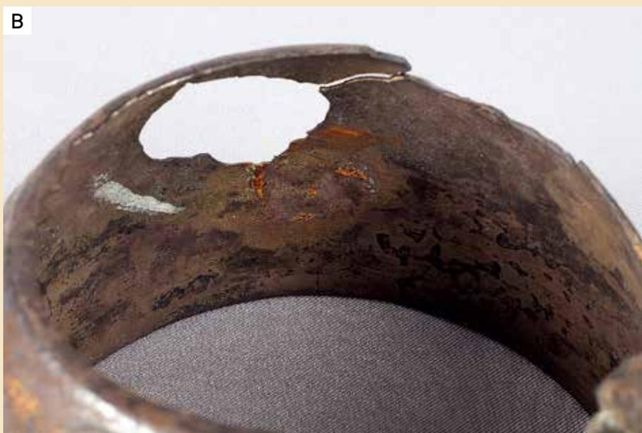
Figura 5: Fractura resultante de desenvolvimento de uma fissura, anverso (A) e reverso (B). ©Archeofactu.
